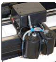
System kart modułowych. Duża niezależność w napełnianiu zbiorników atramentu.
